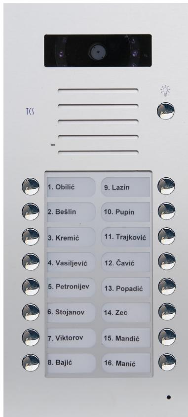
Video kamera je smeštena iza masivne ploče od pleksiglasa koja omogućava nesmetano prikazivanje slike uz maksimalnu zaštitu kamere. Oko kamere su postavljene IC diode tako da kamera može da prikazuje sliku i u mraku kada radi u crno-belom režimu rada. Video modul se može isporučiti u dve varijante:
