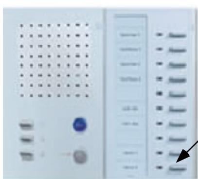
Vrata mogu da se otvore pritiskom na odgovarajući taster dodeljen toj pozivnoj stanicici, bez započinjanja razgovora. Nakon pritiska na taster, dioda koja je do tada treperela, prestaje da svetli.
